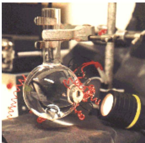
Obrázek 6.2 – Základní informace Dr. WA Steera Sonoluminiscenční experimentální uspořádání.
